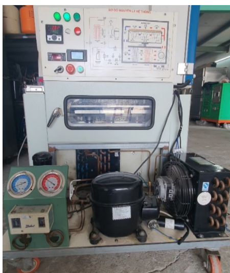
Hình 2. Thiết bị sấy thực nghiệm
