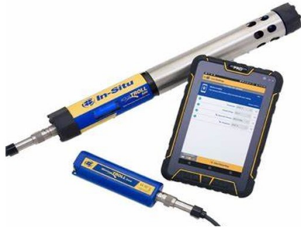
Hình 1. Thiết bị đo chất lượng nước tại hiện trường (Real-time water quality station)
