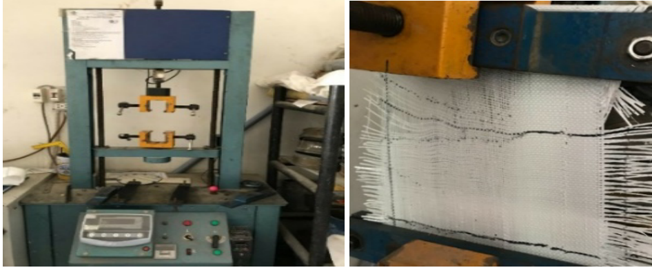
Hình 3. Kiểm tra cường độ chịu kéo của vải địa kỹ thuật
