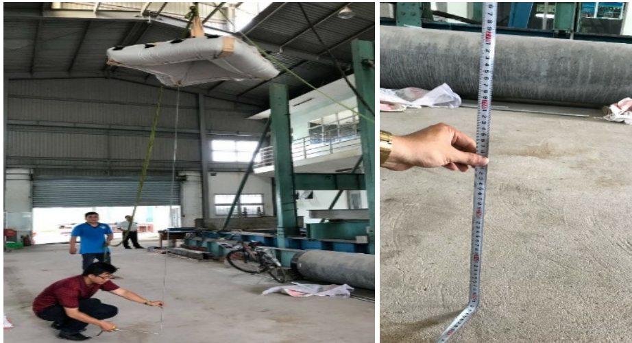
Hình 5. Bố trí thí nghiệm kiểm tra độ bền cơ học của túi cát
