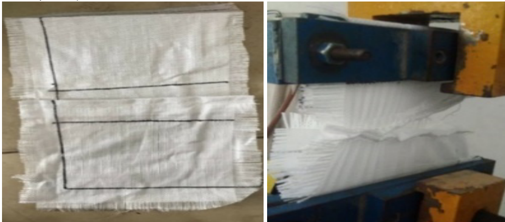
Hình 4. Kiểm tra cường độ chịu kéo của mối nối
