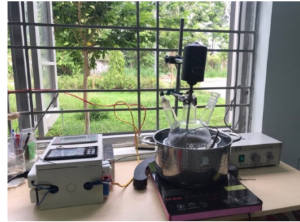
Hình 1. Thiết bị tổng hợp keo trong phòng thí nghiệm
